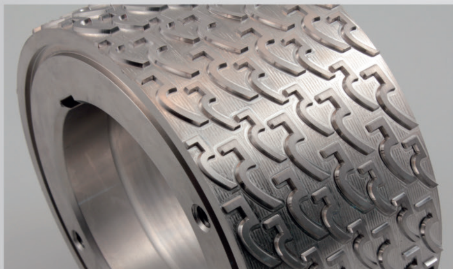
cylindre inox 316 décor relief développé continu marquage : pâte confiserie par roulement
